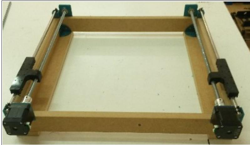
Eje y montaje. Visto desde la parte trasera de la máquina.
